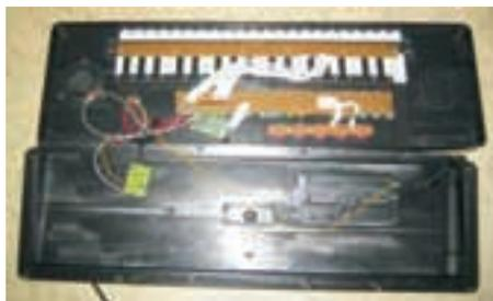
匈牙利通报中国生产的玩具电子琴，通报理由为该玩具不符合欧盟低电压指令，欧洲标准EN62115和EN60065，琴接电源的部分绝缘不够，电线连接插头部分方式错误，容易被拉断，存在电击危险。
