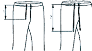
图11 抽绳自由端伸出长度示意
